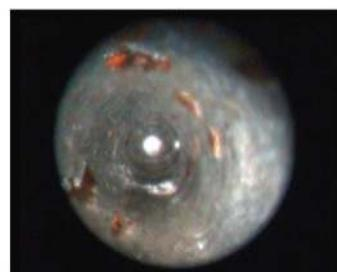
С помощью эндоскопической камеры видно, как очистились каналы охлаждения после 5-ти часов работы установки
